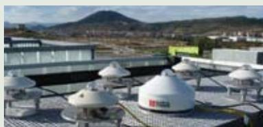
Montaje de piranómetros patrón y mesurandos a calibrar en la sede de CENER
